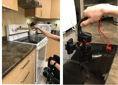
Παράδειγμα προσαρμοσμένου εξοπλισμού που μπορεί να χρησιμοποιηθεί για τον έλεγχο των κουμπιών σόμπας. 17-18
