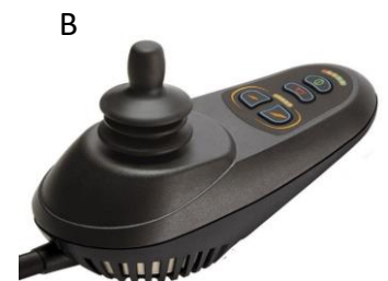
Διάφορα είδη χειριστηρίων, όπως σχήματος U (A), ραβδίου (B), and σφαίρας (C) 5-7
