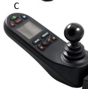
Διάφορα είδη χειριστηρίων, όπως σχήματος U (A), ραβδίου (B), and σφαίρας (C) 5-7
