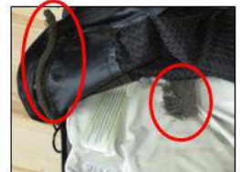
Couverture de mousse qui s'écaille
