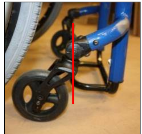
Tige de roulette qui n'est pas alignée avec la roulette. 19
