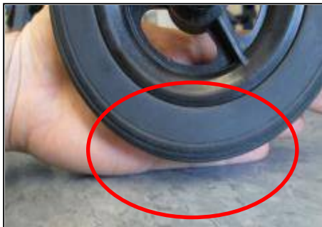
Un exemple de roulette flottante. Notez l'espace entre le bas de la roue et le sol. 18
