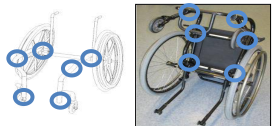
Emplacements communs d'écrous et de boulons sur un fauteuil roulant manuel. 23
