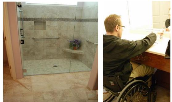
*Une douche sans seuil adaptée avec des barres d'appui et un pommeau de douche à main (à gauche), et un évier avec un espace pour se déplacer en fauteuil roulant (à droite).<sup>11-12</sup>*
