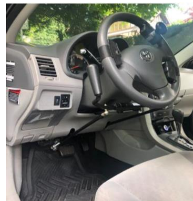
Des tiges peuvent être reliées à l'accélérateur et aux freins pour permettre une conduite à commande manuelle. 18
