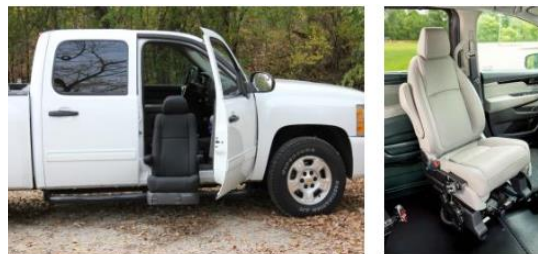
Les sièges auto pivotants peuvent être sortis de la voiture ou tourner à l'intérieur de la voiture. 13,14
