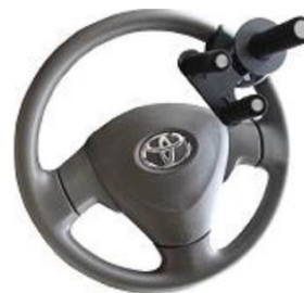
Un bouton rotatif peut être utilisé pour augmenter le contrôle lors de la conduite. 17
