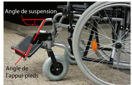
*L'appui-pieds est incliné de manière à l'éloigner du cadre du fauteuil roulant et des montants des roulettes avant.<sup>6</sup>*
