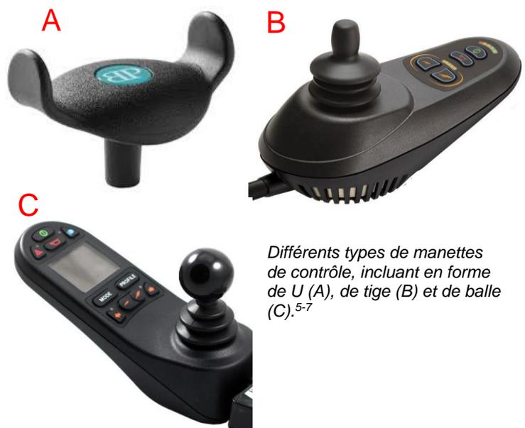
*Différents types de manettes de contrôle, incluant en forme de U (A), de tige (B) et de balle (C).<sup>5-7</sup>*
