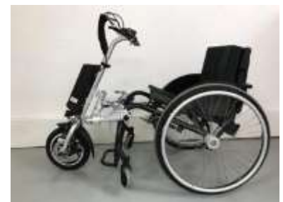
L'utilisation d'un dispositif d'aide à la propulsion peut éliminer l'utilisation des bras pour la propulsion sur un fauteuil. 6
