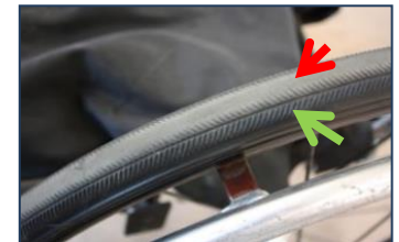
Bande de roulement intacte (verte) et usée (rouge) sur un pneu de fauteuil roulant. 15
