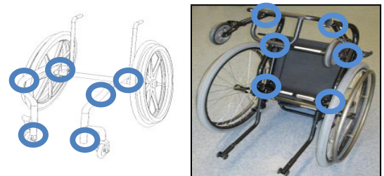
Emplacements communs d'écrous et de boulons sur un fauteuil roulant manuel. 23
