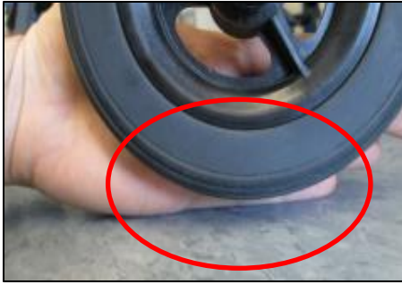
Ένα παράδειγμα από τροχίσκο που δεν εφάπτεται στο έδαφος. Παρατήρησε το κενό μεταξύ της επιφάνειας της ρόδας και του εδάφους. 18
