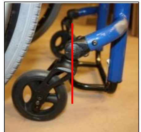
Συνδετικός άξονας που δεν είναι ευθυγραμμισμένος με τον τροχίσκο. 19
